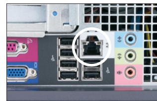
Porta Ethernet ubicata nel pannello posteriore della CPU del computer della IDEXX VetLab Station
