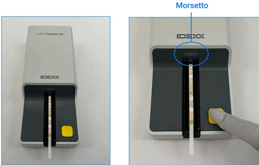
7. Premere il pulsante di **avvio della misurazione**. L'alloggiamento avanza leggermente, la barra di ritenzione si chiude e la striscia rientra nell'analizzatore.
