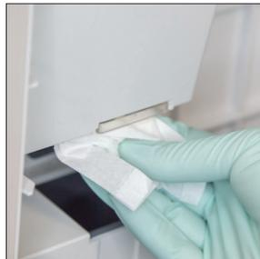
2. Aprire il pannello dell'analizzatore e pulire la parte superiore e inferiore della finestra di pipettatura con un panno per strumenti ottici umido. Quindi asciugare con un nuovo panno per strumenti ottici asciutto.
