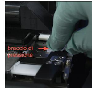
4. Utilizzando un nuovo tamponne di preparazione con alcol sciacquato, pulire il lato sinistro del braccio di pressione 5 volte (assicurandosi che il margine destro del binario sia pulito accuratamente), quindi asciugarlo con un nuovo panno per strumenti ottici.
