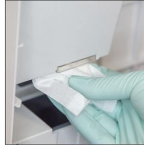
2. Aprire il pannello dell'analizzatore e pulire la parte superiore e inferiore della finestra di pipettatura con un panno per strumenti ottici inumidito di acqua calda. Quindi asciugare con un panno per strumenti ottici asciutto.
