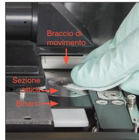
6a. Utilizzando una salvietta imbevuta di alcol nuova, pulire la sezione ottica e il binario ripetutamente per eliminare tutti i residui. Quindi asciugare con un panno per strumenti ottici asciutto.
