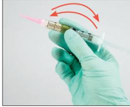
2. Capovolgere delicatamente la siringa 10 volte per miscelare il campione, poi espellere tutta l'aria dalla siringa.
