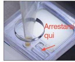
3. Iniettare delicatamente 165 µl di urina attraverso l'apposita apertura e premere il pulsante **Avvio** sull'analizzatore.
