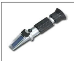
2. Disporre una goccia del campione in un rifrattometro, per ottenere la gravità specifica dell'urina (USG).
