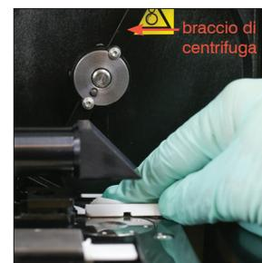
7. Spostare delicatamente il braccio della centrifuga verso sinistra e ispezionare l'area sottostante per verificare la presenza di detriti. Se è sporco, utilizzare una nuova salvietta imbevuta di alcol per pulirlo e poi asciugarlo con un nuovo panno per strumenti ottici.
