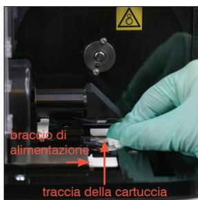
4. Utilizzando una nuova salvietta imbevuta di alcol, pulire accuratamente il binario della cartuccia e il braccio di alimentazione bianco. Quindi asciugare con un nuovo panno per strumenti ottici asciutto.
