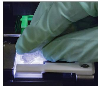
1. Aprire il pannello dell'analizzatore. Quindi, con le mani coperte da guanti, utilizzare un panno per strumenti ottici per assorbire le urine nella parte superiore della cartuccia.
