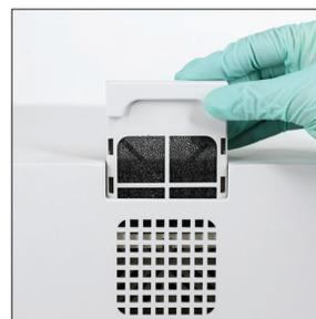
10. Rimuovere il filtro della ventola sul retro dell'analizzatore, sciacquarlo accuratamente con acqua tiepida, asciugarlo tamponando con una salvietta di carta e rimetterlo nella sua posizione nell'analizzatore.
