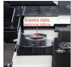
6b. Utilizzando una nuova salvietta imbevuta di alcol (non sciacquata), pulire la finestra della sezione ottica con un movimento circolare (3-4 volte), quindi asciugare con un nuovo panno per strumenti ottici asciutto.
