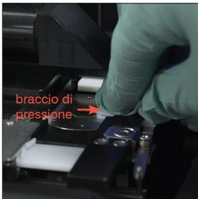
4. Utilizzando una nuova salvietta imbevuta di alcol sciacquata, pulire il lato sinistro del braccio di pressione 5 volte (assicurandosi che il margine destro del binario sia pulito accuratamente), quindi asciugarlo con un nuovo panno per strumenti ottici asciutto.
