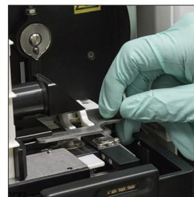
9. Riportare il raccoglitore scarti, il vassoio di gocciolamento, la protezione della centrifuga e il supporto della cartuccia nell'analizzatore nelle rispettive posizioni.
