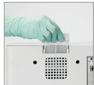
10. Rimuovere il filtro della ventola, sciacquarlo accuratamente con acqua tiepida, asciugarlo tamponando con una salvietta di carta e rimetterlo nella sua posizione nell'analizzatore. Quindi nella schermata della Guida per la pulizia di SediVue Dx, toccare **Fine** per accendere SediVue Dx.
