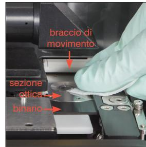
6a. Utilizzando una nuova salvietta imbevuta di alcol sciacquata, pulire la sezione ottica e il binario ripetutamente per eliminare tutti i residui. Quindi asciugare con un nuovo panno per strumenti ottici asciutto.
