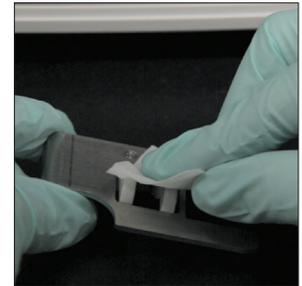
3. Rimuovere il supporto della cartuccia, pulirlo con una nuova salvietta imbevuta di alcol, asciugarlo con un nuovo panno per strumenti ottici asciutto e metterlo da parte.
