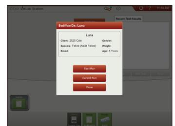
4. Chiudere il pannello dell'analizzatore. Una volta che l'icona di SediVue Dx ha uno stato verde, "pronto", toccare l'icona del paziente nella schermata principale di IDEXX VetLab\* Station e toccare **Avvia analisi**. Una nuova cartuccia viene posta nella finestra di pipettatura.
