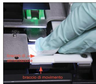
3. Utilizzando una salvietta imbevuta di alcol nuova, pulire il braccio di alimentazione (area di distribuzione), inclusa la parte anteriore del braccio di movimento. Quindi asciugare i componenti con un panno per strumenti ottici.
