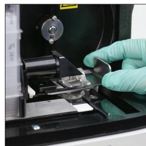
9. Riposizionare il contenitore dei rifiuti, la protezione della centrifuga e il supporto della cartuccia nelle rispettive posizioni nell'analizzatore.
