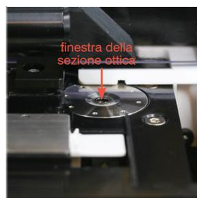
5. Utilizzando una nuova salvietta imbevuta di alcol, pulire la finestra della sezione ottica con un movimento circolare (3-4 volte), quindi asciugare con un movimento circolare utilizzando un nuovo panno per strumenti ottici asciutto.
