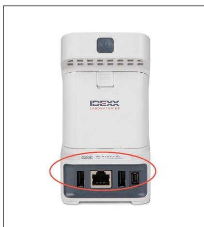
1. Spegnere l'analizzatore e scollegare il cavo di alimentazione e/o Ethernet.
