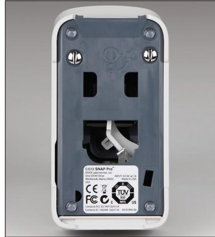
8. Accertarsi che la base e gli elementi di fissaggio color argento siano a filo dell'analizzatore e correttamente inseriti.
