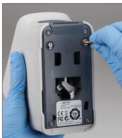
2. Sul fondo dell'analizzatore spento, utilizzare un cacciavite a punta piatta o una moneta per girare di un quarto di giro in senso antiorario i 2 elementi di fissaggio color argento.
