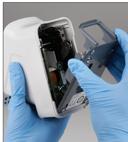
6. Una volta fatta asciugare la base, fissarla nuovamente all'analizzatore e accertarsi che sia ben inserita in posizione.
