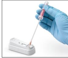
3. Spremere il bulbo per rilasciare **5 gocce** nel pozzetto per campioni del dispositivo SNAP Parvo.
