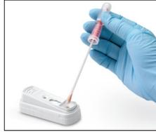
3. Spremere il bulbo per rilasciare **5 gocce** nel pozzetto per campioni del dispositivo SNAP Giardia
