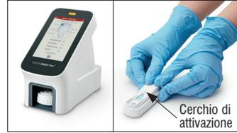
4. È possibile utilizzare l'analizzatore SNAP Pro\* per attivare automaticamente lo SNAP test e interpretarne i risultati.
