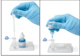
1. Utilizzando la pipetta fornita, erogare **3 gocce di campione** e **4 gocce di coniugato** nella provetta.
