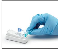
3. Versare l'intero contenuto della provetta nel pozzetto per campioni del dispositivo SNAP 4Dx Plus.
