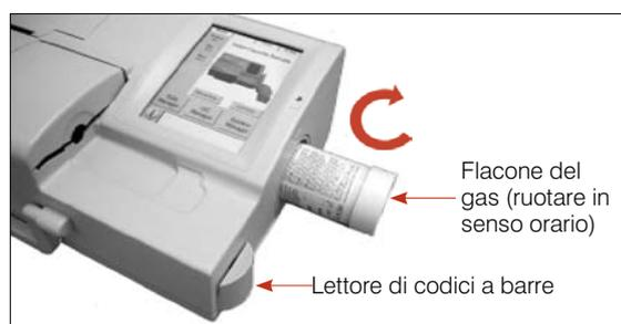
**Figura A-4:** Flacone del gas e lettore di codici a barre
